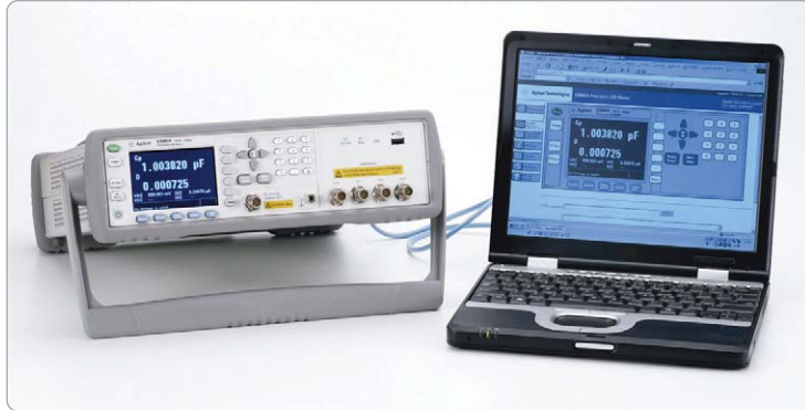
図12. E4980A LCRは、コンピュータとWebブラウザを使ってLANから制御可能
