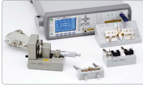
図10. E4980A LCRはさまざまなテスト・フィクスチャをサポートしています。
